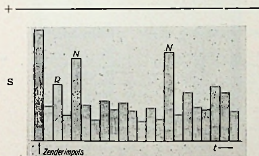
In de storagetube worden de drie achtereenvolgende beelden P-Q-R opgeteld; het resultaat zien we in S
